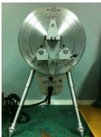
ภาพที่ 3-15 เครื่องวัดค่าความแข็งตึงของกระดาษ
