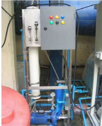
รูปที่ 3.3 ระบบนาโนฟิลเตรชันที่ใช้ในการทดลอง
