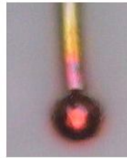
ภาพที่ 4.4 การเกิดออกไซด์ขณะสร้าง Free Air Ball (FAB)
