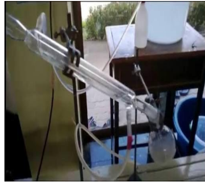
รูปที่ 3.22 แยกเอทานอลและน้ำมันดีเซลออกจากน้ำมันตัวอย่าง
