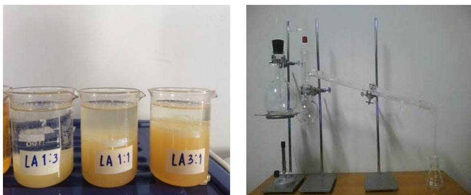
รูปที่ 3.15 แยกตัวทำละลายเอทานอลและน้ำมันดีเซลออกจากน้ำมันตัวอย่าง
