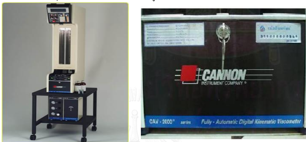
รูปที่ 3.3 เครื่องวัดความหนืดแบบอัตโนมัติ CANNON VISCOSITY METER รุ่น CAV – 2000
