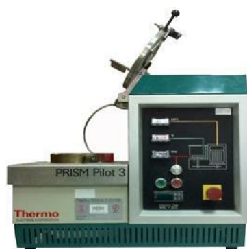
รูปที่ 4.6 เครื่องผสมความเร็วสูง (High speed mixer, Thermo Prism Pilot 3)
