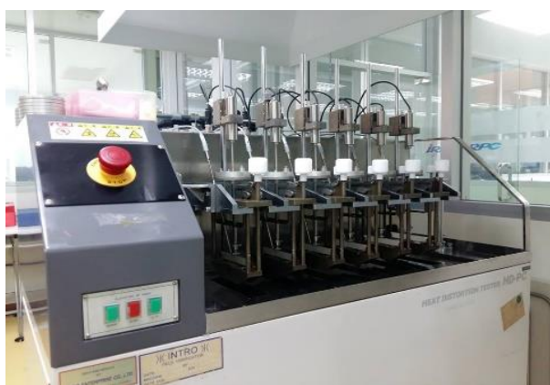
รูปที่ 4.11 เครื่อง Heat distortion Tester (YASUDA No.148)
