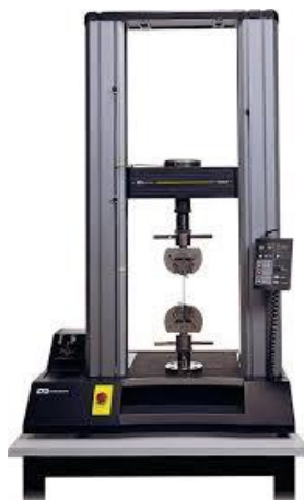
รูปที่ 4.14 เครื่อง Universal machine testing (INSTRON Instrument รุ่น 5567)
