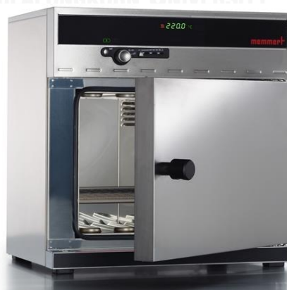
รูปที่ 4.9 ตู้อบลมร้อน (Oven, Memmert UNB 400)
