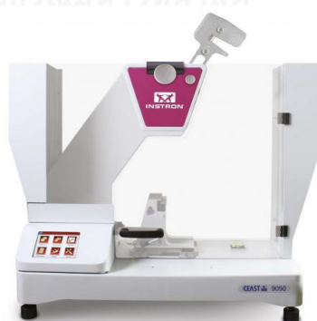
รูปที่ 4.15 เครื่องทดสอบแรงกระแทก (INSTRON CEAST 9050)
