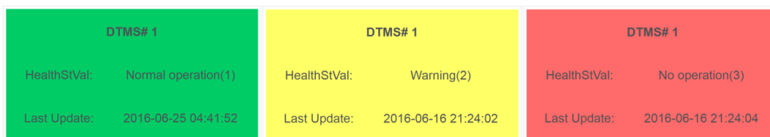
รูปที่ 77 สถานะการทำงานของหม้อแปลงไฟฟ้าระบบจำหน่าย
