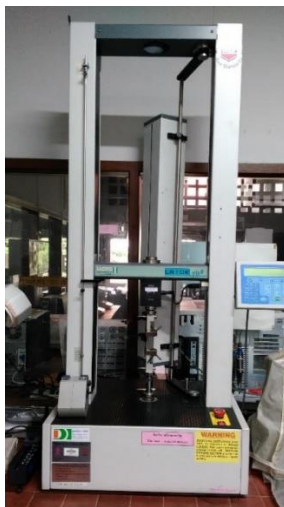
รูปที่ 3.6 เครื่องทดสอบสมบัติเชิงกล Universal testing machine
