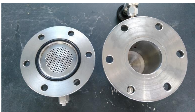
รูปที่ 3.3 เซลล์หน้าแปลนเมมเบรน
