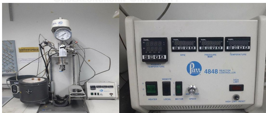
รูปที่ 3.1 เครื่องปฏิกรณ์ Parr Reactor Model 4848
