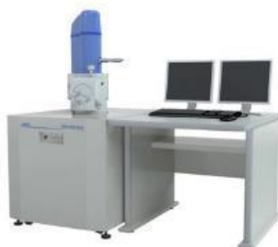
รูปที่ 3.4 เครื่องวิเคราะห์สัณฐานวิทยาจุลทรรศน์อิเล็กตรอนแบบส่องกราด [37]
