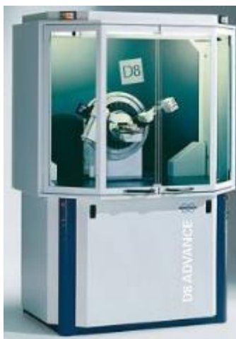
รูปที่ 3.3 เครื่องวิเคราะห์การเลี้ยวเบนรังสีเอ็กซ์ [36]
