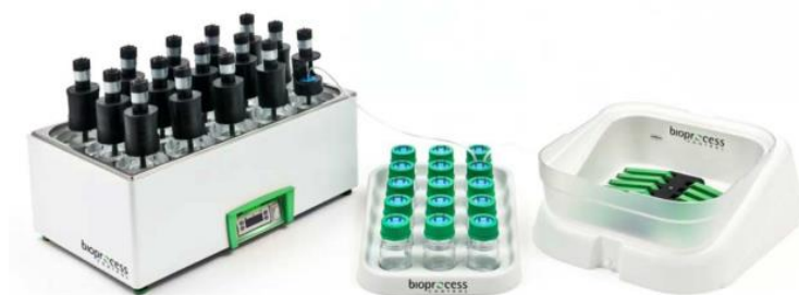
รูปที่ 3.1 ชุดการทดลองหมักก๊าซชีวภาพแบบวัดปริมาณก๊าซมีเทนอัตโนมัติ
