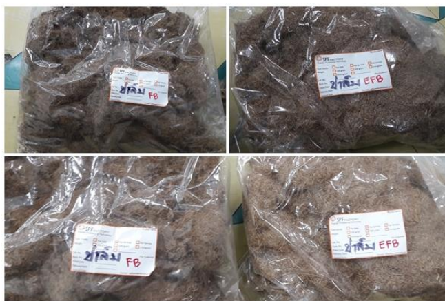
รูปที่ 3.4 ทะลายปาล์มเปล่าและเส้นใยปาล์มหลังการปรับสภาพโดยวิธีทางกายภาพ
