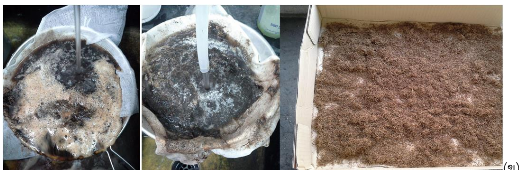
ทะลายปาล์มเปล่าและเส้นใยปาล์มที่ผ่านการปรับสภาพแล้ว รูปที่ 3.5 ขั้นตอนการปรับสภาพทะลายปาล์มเปล่าและเส้นใยปาล์มโดยวิธีทางเคมี
