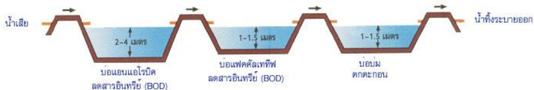
ภาพที่ 3.9 การวางท่อของระบบบ่อปรับเสถียร (Stabilization Pond)
