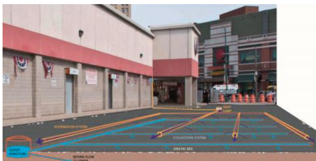
ภาพที่ 2.14 การควบคุมการสร้างพื้นที่ที่ส่งเสริมการกักเก็บน้ำ
