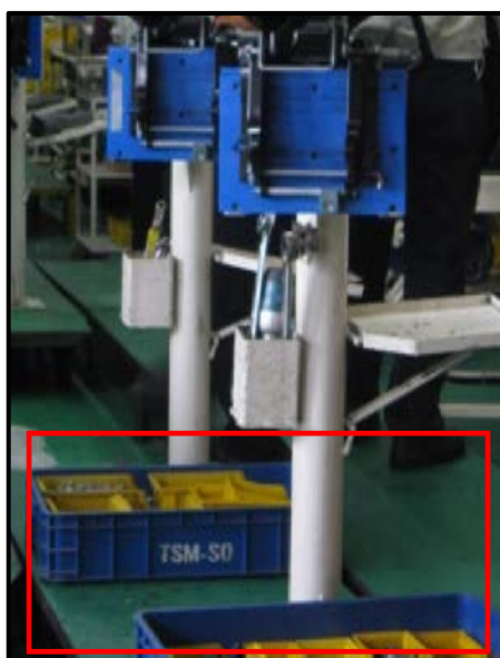
รูปที่ 4.2 Tray ที่มีช่องเก็บของวางไว้บน Tray ที่เป็นรถลากของพนักงาน (หลังปรับปรุง)
