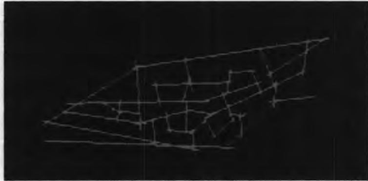
แผนที่ 2.5 โครงข่ายเส้นตรง (axial line) ของพื้นที่เมืองกัสแซงค์ ประเทศฝรั่งเศส (ที่มา: Hillier, 1996 อ้างถึงใน ไชศรี ภักดีสุขเจริญ, 2548)
