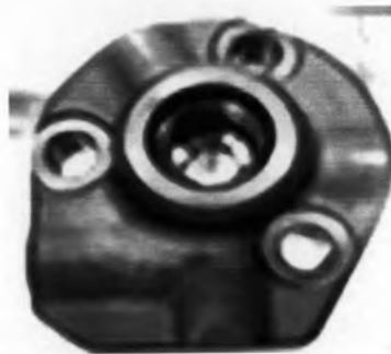
รูปที่ 3.7 กระบอกสูบปั๊มหลังการขึ้นรูปด้วยไฟฟ้า
