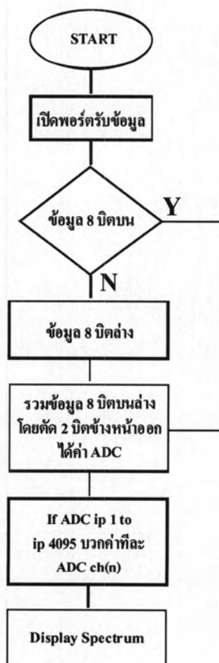
รูปที่ 3.14 โฟล์วชาร์ตการส่งข้อมูลไปยังคอมพิวเตอร์
