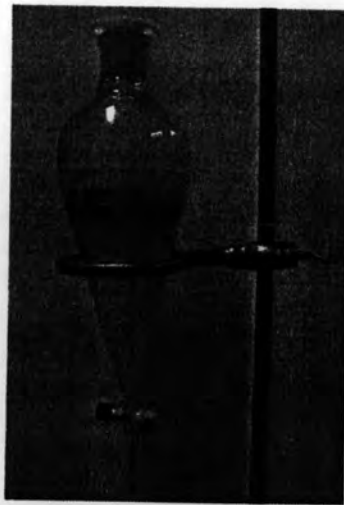
รูปที่ 9 การแยกชั้นของผลิตภัณฑ์กับน้ำจากการทดลอง
