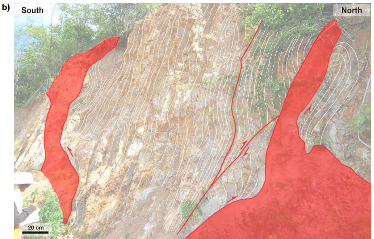
รูปที่ 4.11 (a) รูปบน รูปถ่ายหินโผล่ในตำแหน่งศึกษาที่ 3 จุดที่ 2 แสดง (b) รูปล่าง ลักษณะชั้นหินที่วางตัวเกือบตั้งฉากกับแนวระนาบ ซึ่งเป็นผลจากแรงกระทำต่อพื้นที่ที่ค่อนข้างมาก ทำให้เกิดรอยเลื่อนและมีการเปลี่ยนแปลงลักษณะการวางตัวของชั้นหินในลักษณะนี้ (เส้นสีแดงแทนระนาบรอยเลื่อน พื้นที่สีแดงแสดงเขตรอยเลื่อน เส้นสีขาวแสดงแนวการวางตัวของชั้นหินและเส้นประแสดงระนาบที่ไม่แน่ชัด)
