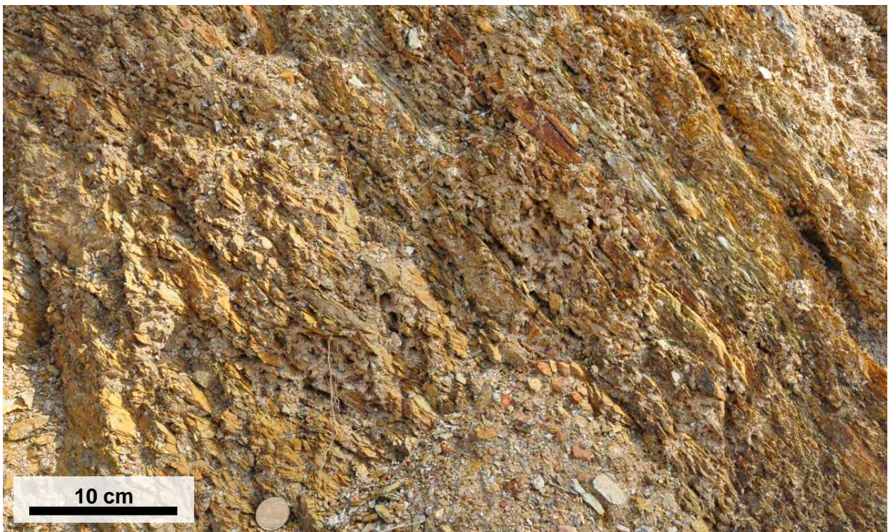
รูปที่ 4.4 หน่วยหิน C หินดินดาน มีสีฝูสีน้ำตาลถึงสีน้ำตาลเข้ม สะสมตัวอย่างต่อเนื่องเป็นชั้นบางๆ ลักษณะของ หินโคลมีความนุ่มมาก มีค่าการวางตัวของชั้นหิน 175^{\circ}/28^{\circ}\text{SW}
