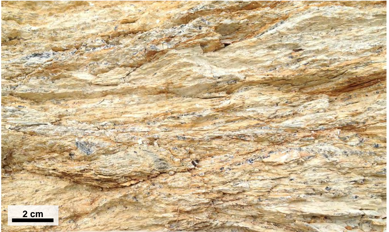
รูปที่ 4.3 หน่วยหิน B หินดินดานเนื้อปนซิลิกา สีน้ำตาลอ่อน ซึ่งพบหินเชิร์ตซึ่งประกอบด้วยซิลิกา สีเทาถึงสีเทา เข้มสะสมตัวเป็นชั้นบางๆขนาด 0.2-1 เซนติเมตร และเลนส์ แทรกอยู่ในชั้นหินดินดาน มีค่าการวางตัวของชั้นหิน 160^{\circ}/40^{\circ}\text{SW}
