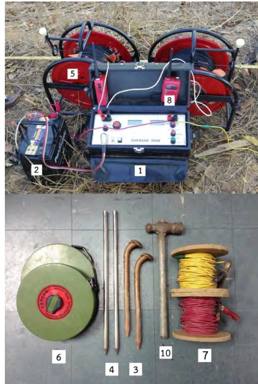
รูปที่ 3.1 อุปกรณ์สำหรับการศึกษาทางธรณีฟิสิกส์ โดยสำรวจวัดสภาพต้านทานไฟฟ้า แบบ 1 มิติ การจัดวางอิเล็กโทรดแบบซิมเบอร์เจอร์
