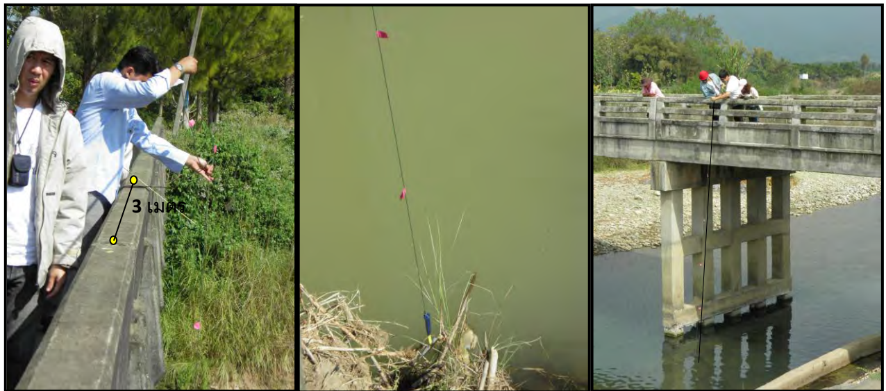
รูปที่ 3.6: แสดงการวัดขนาดและความลึกของแม่น้ำ โดยมีระยะห่างทุกๆ 3 เมตร
