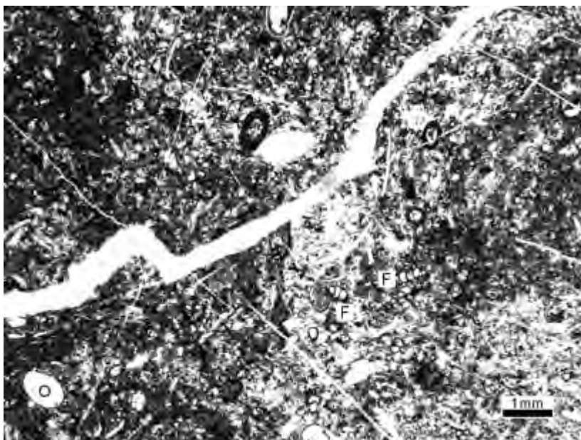
รูปที่ 2.55 หินแควสโตนตัวอย่าง KM34-1 เม็ดตะกอนประกอบด้วย ฟอแรมินิเฟอรา (F) ออสตราคอด (O) เศษหินชีวภาพขนาดละเอียด และเพลลอย หินมีเนื้อพื้นเป็นแคลไซต์เมทริกซ์ พบสายแร่แคลไซต์ขนาด ประมาณ 0.8 มิลลิเมตรตัดผ่าน
