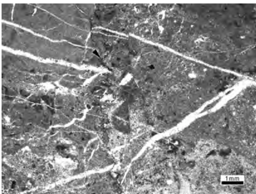
รูป 2.58 หินมัตสโตนตัวอย่าง KM35-2 เนื้อหินประกอบด้วยเมทริกซ์ประมาณ 95% เม็ดตะกอนที่พบคือ เพลลลอยพบแนวพินในเนื้อหิน (ลูกศรสีดำ) และพบสายแร่แคลไซต์ขนาดประมาณ 0.4 มิลลิเมตรตัดผ่าน
