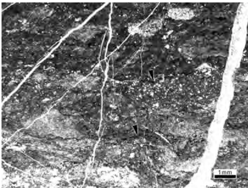
รูป 2.56 หินมัตสโตนตัวอย่าง KM34-2 เนื้อหินประกอบด้วยเมทริกซ์เกือบทั้ง 100% ส่วนสีเข้มของเนื้อหินแสดงการเจริญเติบโตของแบคทีเรีย พบแนวฟันในเนื้อหินแสดงแนวเส้นสีดำขนานกัน (ลูกศรสีดำ) พบสายแร่แคลไซต์ขนาดประมาณ 1 มิลลิเมตร
