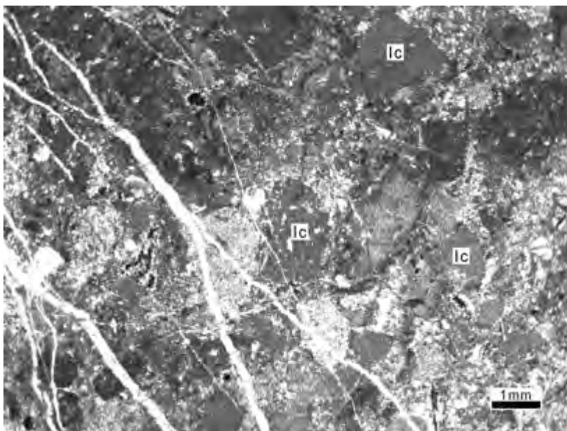
รูป 2.20 หินแวคสโตนตัวอย่าง KM15-3 เม็ดตะกอนที่พบประกอบไปด้วย อินทราคลาสต์ของมัดสโตน (lc) ลักษณะกึ่งกลมมน มีเนื้อพื้นเป็นแคลไซต์เมทริกซ์ และถูกเชื่อมประสาน ด้วยแร่แคลไซต์ พบสายแร่แคลไซต์ขนาดเล็กกว่า 0.1 มิลลิเมตร และขนาด 0.1 มิลลิเมตรตัดผ่าน
