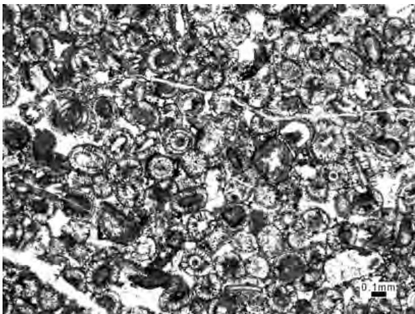
รูป 2.6 หินเกรนสโตนตัวอย่าง KM6-1 เม็ดตะกอนที่พบแสดงลักษณะการพอกแบบเม็ดไข่ปลา ขนาดตะกอนประมาณ 0.1-0.3 มิลลิเมตร โดยเป็นการพอกทั้งแบบปริศมีและการพอกที่เป็นชั้นบางๆ ล้อมรอบเศษหินชีวภาพ ฟอแรมินิเฟอรา เฟลลอย ช่องว่างระหว่างตะกอนถูกเชื่อมประสานด้วยแร่แคลไซต์ พบสารแร่แคลไซต์ขนาด 0.1 มิลลิเมตรตัดผ่าน
