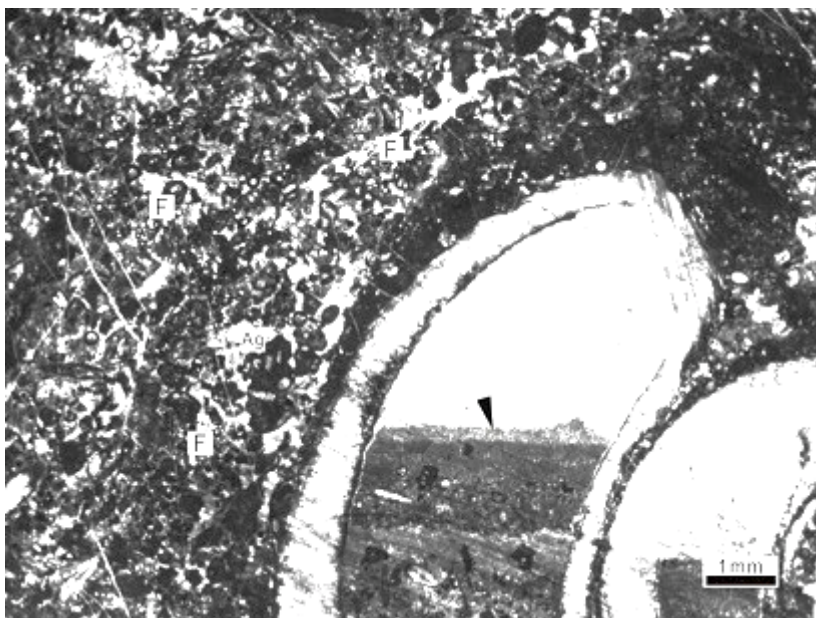
รูป 2.24 หินแพคสโตนตัวอย่าง KM16-4 เม็ดตะกอนประกอบด้วย ฟอแรมินิเฟอรา (F) ตะกอนมวลรวม (Ag) เพลลลอย และเศษเปลือกหอยฝาเดียวที่ถูกเติมด้วยตะกอนและเศษหินซีวภาพขนาดละเอียด แสดงลักษณะ geopetal บ่งบอกแนวการสะสม (ลูกศรสีดำ)
