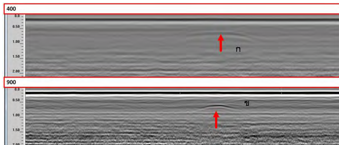
รูป 4.1. การสำรวจด้วย GPR แสดงผลที่ได้จากการทดสอบความถี่ของหัววัด (ก) ความถี่ 400 MHz และ (ข) ความถี่ 900 MHz
