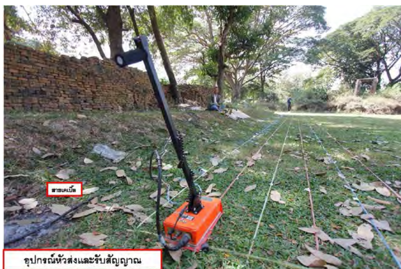
รูป 2.6. อุปกรณ์ในการสำรวจด้วยวิธี GPR แสดง อุปกรณ์หัวส่งและรับสัญญาณ และ สายเคเบิล
