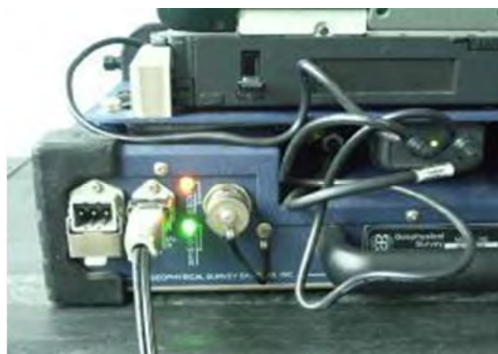
รูปที่ 3.10 ภาพถ่ายการเชื่อมต่อเครื่องมือและอุปกรณ์ในการสำรวจธรณีฟิสิกส์ด้วยเรดาร์
