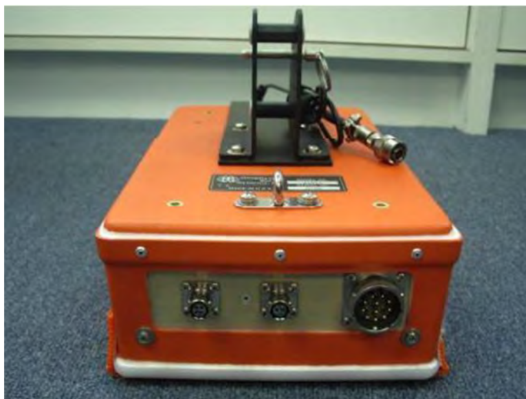
รูปที่ 3.5 ภาพถ่ายเครื่องมือตัวรับและส่งสัญญาณของการสำรวจธรณีฟิสิกส์ด้วยเรดาร์
