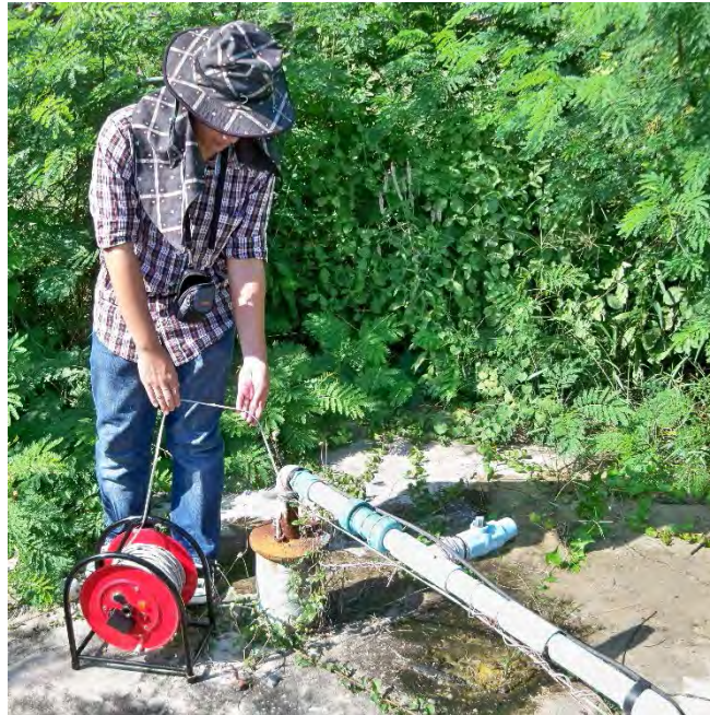
รูปที่ 4.2 การวัดระดับน้ำบาดาลโดยใช้ขั้วไฟฟ้า
