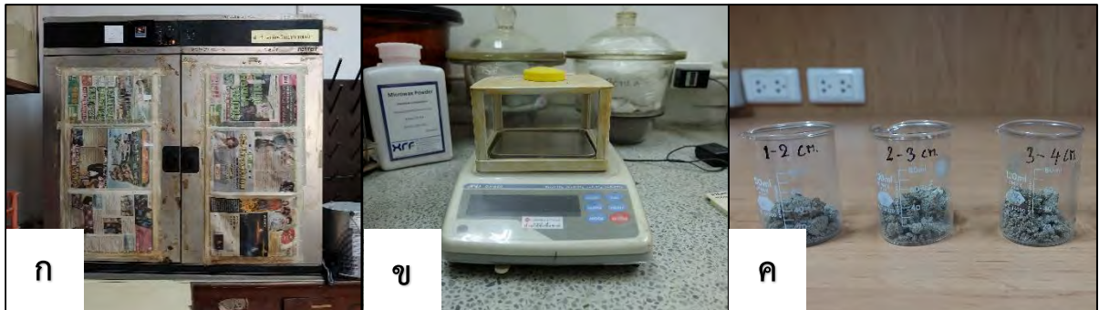
รูปที่ 2.11 แสดงอุปกรณ์ที่ใช้ในการหาค่าการกระจายตัวของขนาดเม็ดตะกอนโดยใช้เครื่อง Laser particle size distribution analyzer (PSD) ในห้องปฏิบัติการ
