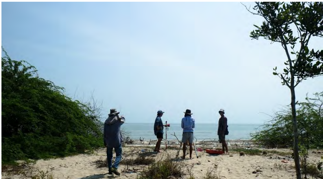
รูปที่ 2.2 แสดงการวัดระดับความลาดชันของชายหาดในแนวตั้งฉากกับหน้าหาด
