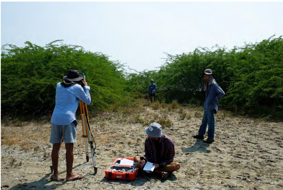
รูปที่ 2.4 แสดงการวัดระดับความลาดชันของชายหาดพร้อมกับบันทึกผลการวัด
