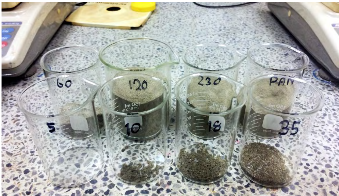
รูปที่ 2.17 แสดงตัวอย่างตะกอนที่ได้ในตะแกรงคัดขนาดแต่ละเบอร์แยกไว้ในแต่ละบีกเกอร์
