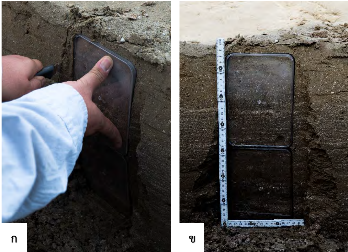
รูปที่ 2.9 แสดงการเก็บตัวอย่างตะกอนในแนวตั้ง (ก) นำกล่องตัวอย่าง (lunch box) มาเก็บตะกอน และ (ข) เก็บตัวอย่างตะกอนลึกจากพื้นผิว 30-40 เซนติเมตร
