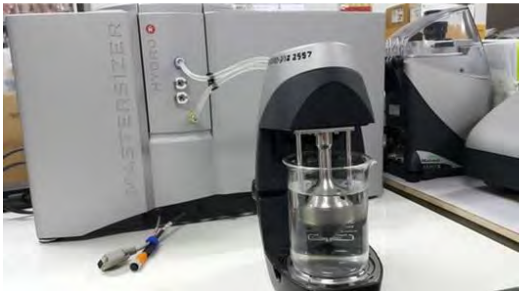
รูปที่ 2.12 เครื่อง Laser particle size distribution analyzer (PSD)
