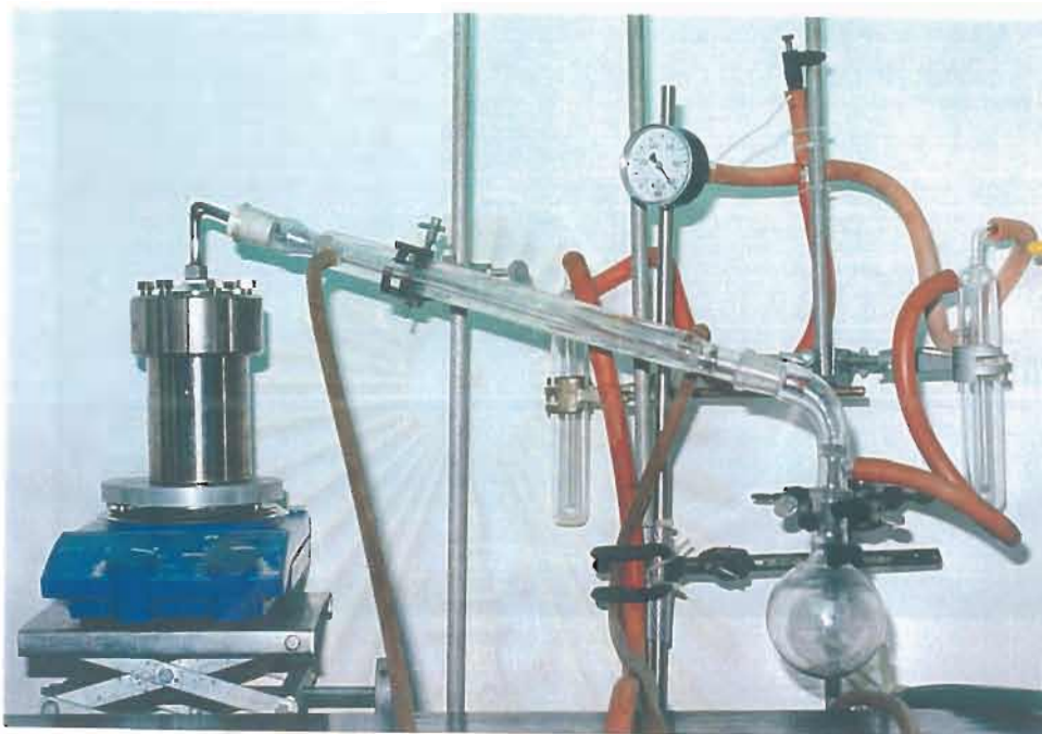
รูปที่ 1 อุปกรณ์ชุดกำจัดปรอทด้วยการให้ความร้อน
