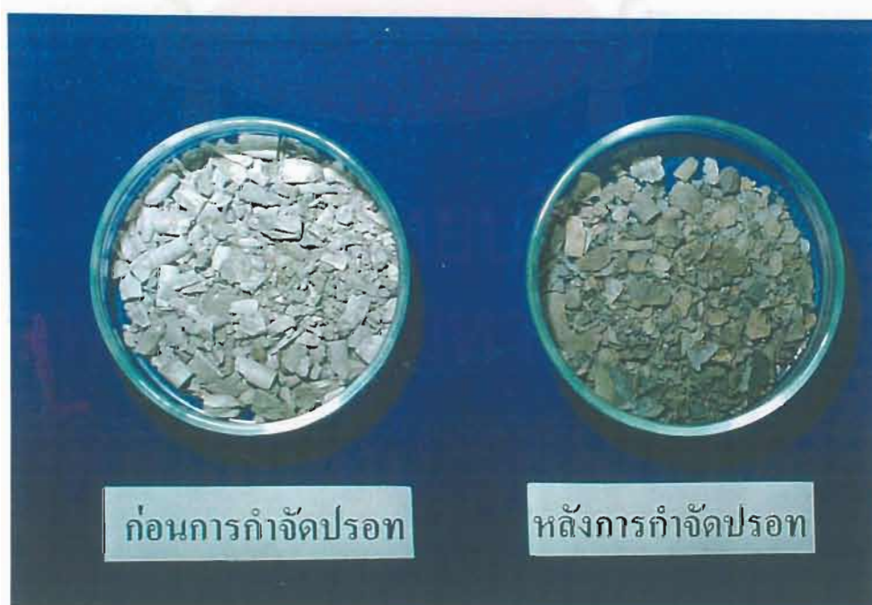
รูปที่ 2 โลหะเจืออะมัลกัมก่อนและหลังการกำจัดปรอท
