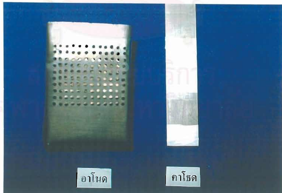
รูปที่ 4 ขั้วไฟฟ้าที่ใช้ในการศึกษาตัดแปลงจากแผ่นไททานเนียมเคลือบแพลทินัม
