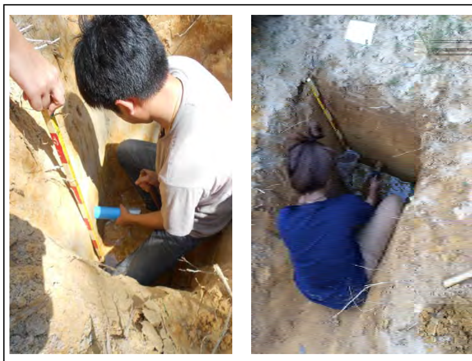
รูปที่ 2.4 การเก็บตัวอย่างสำหรับ Equivalent dose (ซ้าย) และตัวอย่างสำหรับ Annual dose (ขวา)
