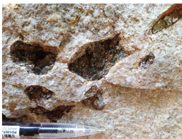
รูป 4.8 ลักษณะชั้นหิน breccia limestone พบเป็น clast ของหินภูเขาไฟประเภท mafic แทรกอยู่ในหินปูน ตั้งแต่ขนาดเส้นผ่านศูนย์กลาง 2-20 เซนติเมตร บริเวณพนมจัญเจียง A
