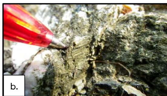
ภาพที่ 3.12 ภาพถ่ายลักษณะปรากฏของระบายรอยเลื่อน และเส้นรอยเลื่อนที่พบในหินโผล่ในพื้นที่ศึกษาละเอียด
