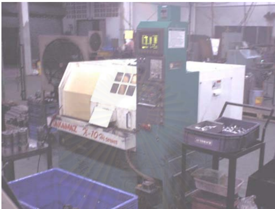
รูปที่ 3.8 รูปแสดงเครื่องกลึง CNC ชนิดป้อมมิดที่หมุนได้ (CNC Turret Lathe)
