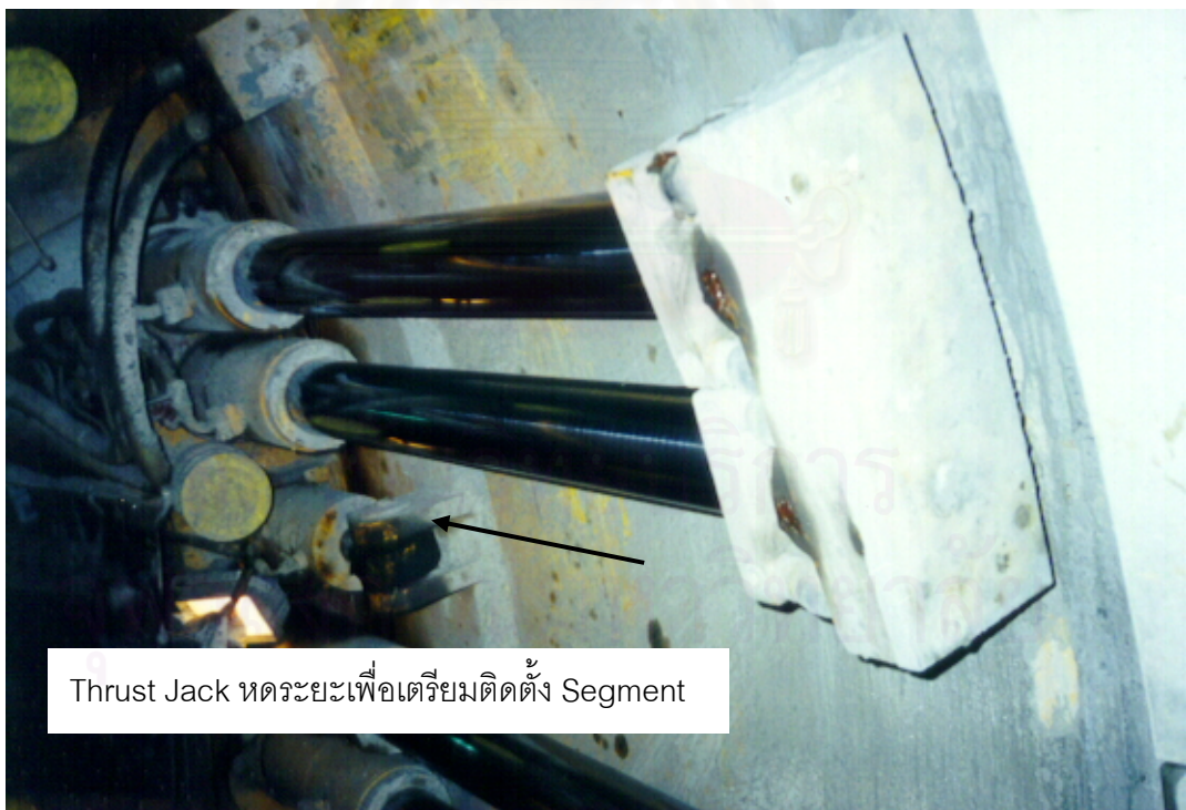
รูปที่ 3.9 แสดงการลดระยะของ Thrust Jack เพื่อติดตั้ง Segment
