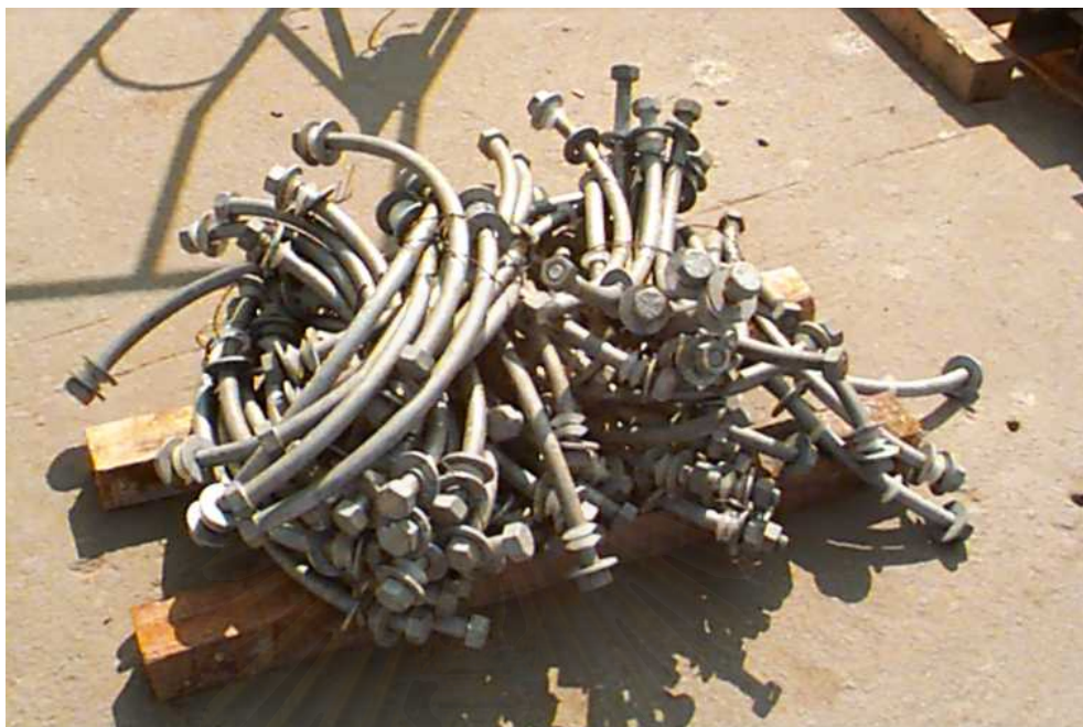
รูปที่ 3.26 แสดงสลักเกลียวรูปตัวยู (Curve Bolt)
