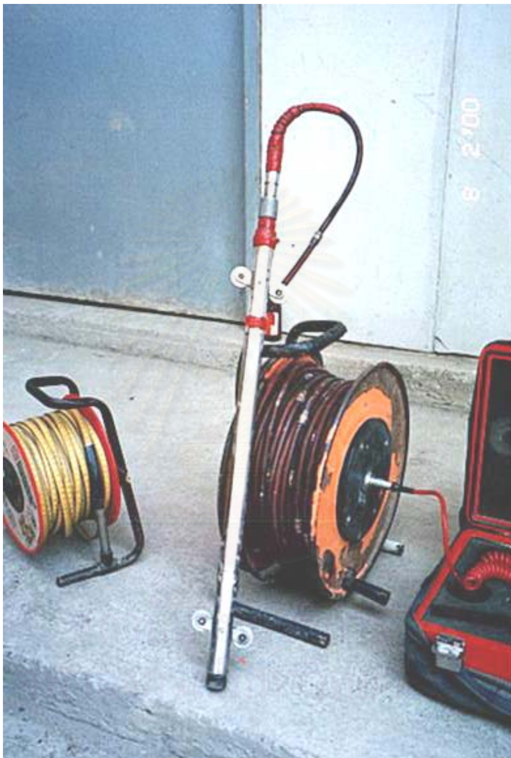
รูปที่ 4.5 แสดงเครื่องมือวัด Inclinometer
