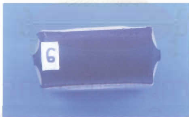
รูปที่ 4.69 : ความต้านทานต่อความล้าด้านพลศาสตร์ สำหรับ การบ่มที่ 300 องศาฟาเรนไฮต์ เวลา 120 นาที
