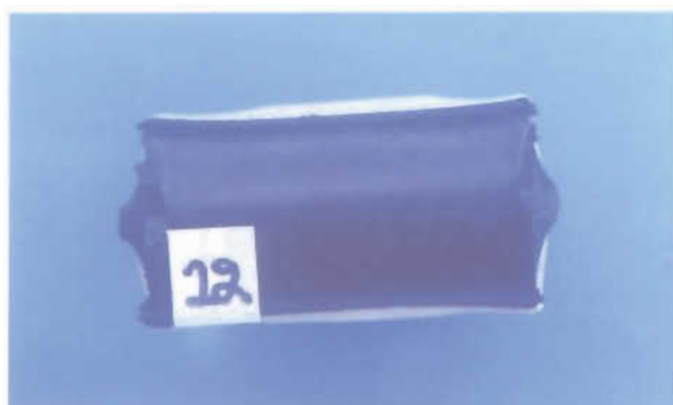
รูปที่ 4.67 : ความต้านทานต่อความล้าด้านพลศาสตร์ สำหรับ การบ่มที่ 270 องศาฟาเรนไฮต์ เวลา 960 นาที
