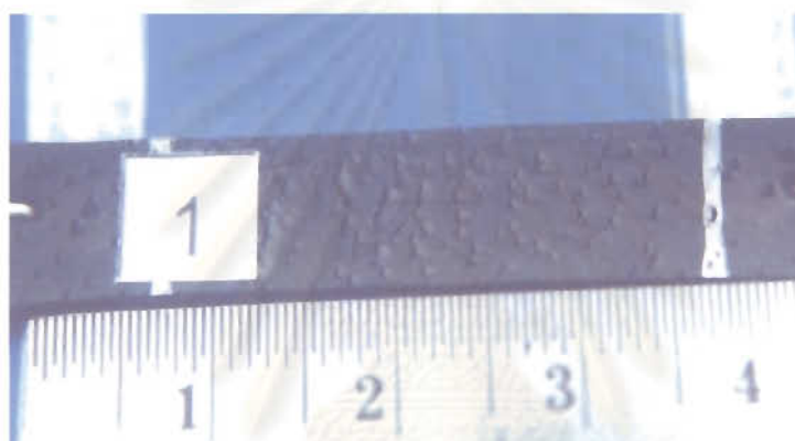
รูปที่ 4.80 : ลักษณะของชิ้นตัวอย่างที่ทำการทดสอบความต้านทานต่อไอโซน สำหรับ การบ่มที่ 270 องศาฟาเรนไฮต์ เวลา 960 นาที
