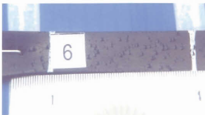
รูปที่ 4.83 : ลักษณะของชิ้นตัวอย่างที่ทำการทดสอบความต้านทานต่อไอโซน สำหรับ การบ่มที่ 300 องศาฟาเรนไฮต์ เวลา 192 นาที
