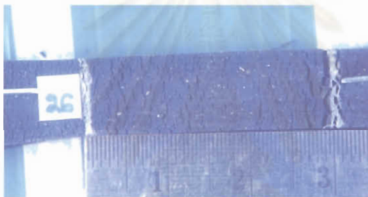
รูปที่ 4.106 : ลักษณะของชิ้นตัวอย่างของแบลคเดอริ์ บ่มเวลา 22 นาที ที่ทำการทดสอบความต้านทานต่อไอโซน.
