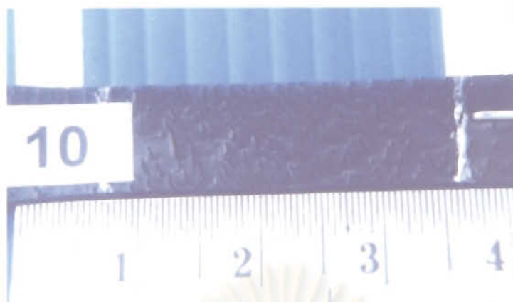
รูปที่ 4.77 : ลักษณะของชิ้นตัวอย่างที่ทำการทดสอบความต้านทานต่อไอโซน สำหรับการบ่มที่ 270 องศาฟาเรนไฮต์ เวลา 364 นาที
