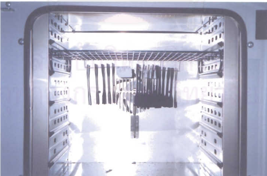
รูปที่ 3.6 : การวางชิ้นตัวอย่างในตู้อบ เพื่อให้ความร้อนกระจายทั้งตู้.
