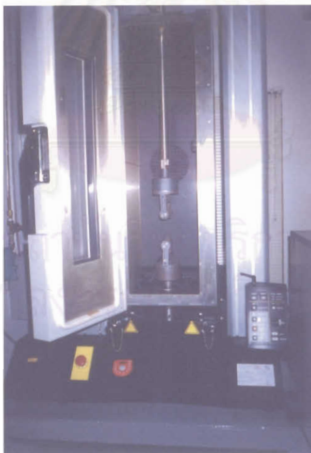
รูปที่ 3.11 : เครื่องทดสอบความต้านแรงดึง ที่สามารถทดสอบในตู้อบ.
