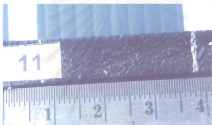
รูปที่ 4.77 : ลักษณะของชิ้นตัวอย่างที่ทำการทดสอบความต้านทานต่อไอโซน สำหรับการบ่มที่ 270 องศาฟาเรนไฮต์ เวลา 364 นาที
