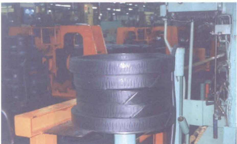
รูปที่ 2.2 : การเตรียมสลักแบลดเดอร์ก่อนเข้ากระบวนการบ่ม.
