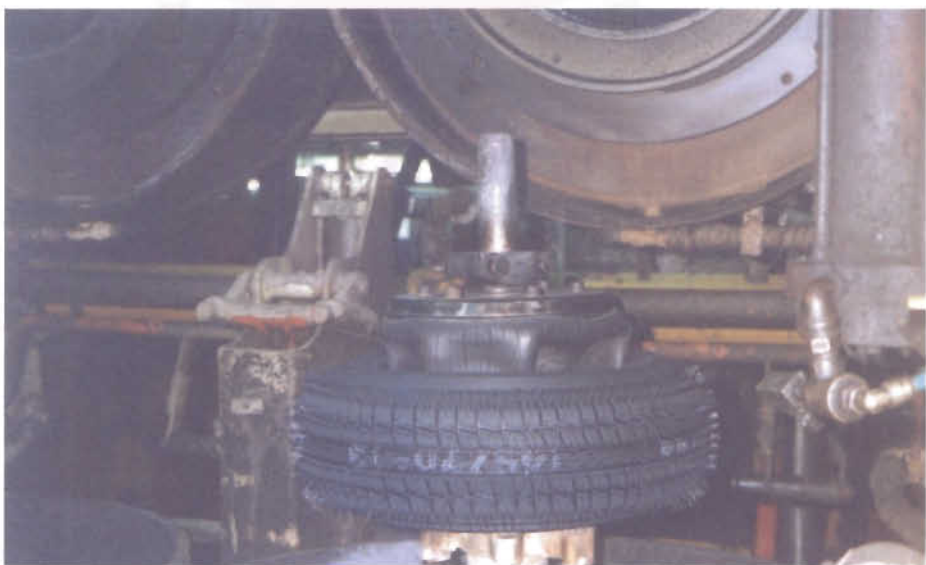
รูปที่ 2.5 : เบลตเตอร์ประกอบเข้ากับเครื่องบ่มของยางรถยนต์
