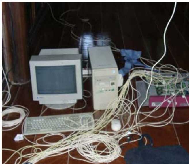
ภาพที่ 3.1 แสดงการต่อเครื่องคอมพิวเตอร์บันทึกข้อมูลร่วมกับเครื่องเก็บอุณหภูมิ System 200
