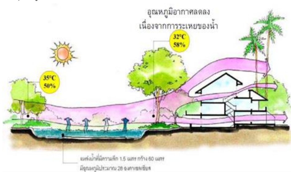
รูปที่ 2.13 แสดงการลดอุณหภูมิอากาศโดยการระเหยของน้ำ จากอิทธิพลแหล่งน้ำ
