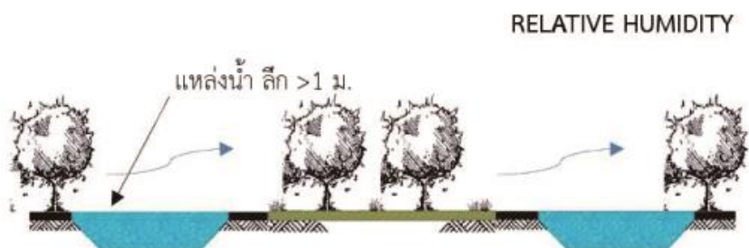
รูปที่ 5.4 แสดงการใช้อิทธิพลแหล่งน้ำที่มีค่าความจุความร้อนสูง การระเหยของน้ำและความเร็วลม ส่งผลต่อการเพิ่มปริมาณความชื้นสัมพัทธ์ในอากาศ ทำให้อุณหภูมิอากาศลดลง
