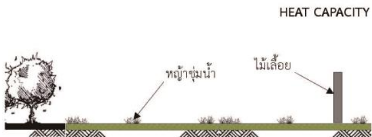
รูปที่ 5.5 แสดงการใช้สิ่งปกคลุมพื้นผิวหญ้าชุ่มน้ำที่มีค่าความจุความร้อนสูง สามารถรองรับการ เพิ่มขึ้นของอุณหภูมิอากาศที่เกิดจากการตกกระทบของรังสีดวงอาทิตย์
