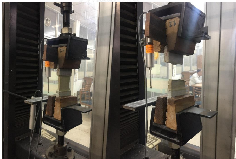
รูปที่ 4. 7 การทดสอบแรงดึงของชิ้นส่วนตัวอย่างที่ผ่านการเคลือบสารเคลือบผิวอะคริลิก (C) หลังเร่งปฏิบัติการสภาพอากาศ
