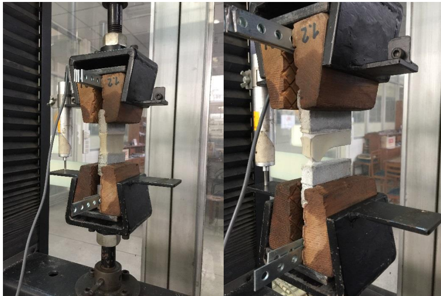
รูปที่ 4. 6 การทดสอบแรงดึงของชิ้นส่วนตัวอย่างที่ไม่ผ่านการเคลือบสาร (NC) หลังเร่งปฏิบัติการสภาพอากาศ
