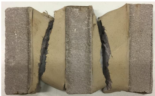
รูปที่ 4. 18 ลักษณะการพังของชิ้นส่วนตัวอย่างเมื่อผ่านการทดสอบแรงเฉือน
