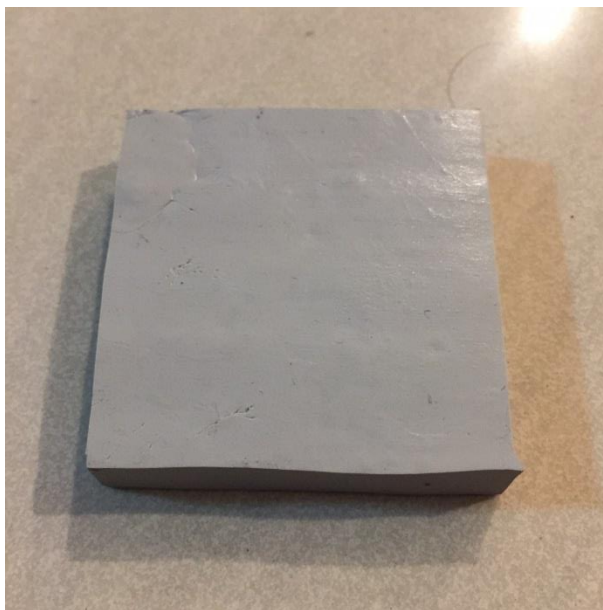
รูปที่ 3. 4 ชิ้นส่วนตัวอย่างสำหรับทดสอบความแข็ง
