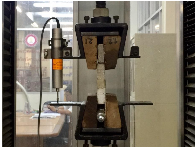
รูปที่ 4. 4 การติดตั้งชิ้นส่วนตัวอย่างที่ใช้ทดสอบแรงดึง
