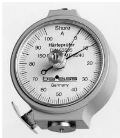
รูปที่ 2. 16 เครื่องมือวัดความแข็งแบบชอร์เอ ( www.substech.com )
