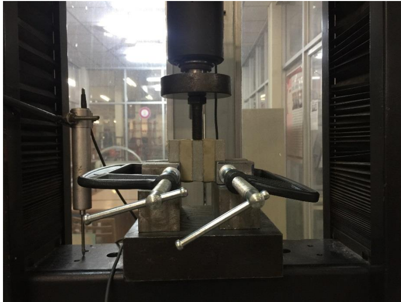
รูปที่ 4. 16 ก่อนทำการทดสอบแรงเฉือนของชิ้นส่วนตัวอย่าง
