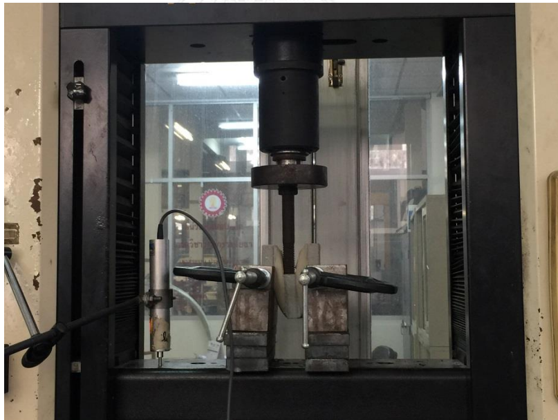
รูปที่ 4. 17 การทดสอบแรงเฉือนของชิ้นส่วนตัวอย่าง
