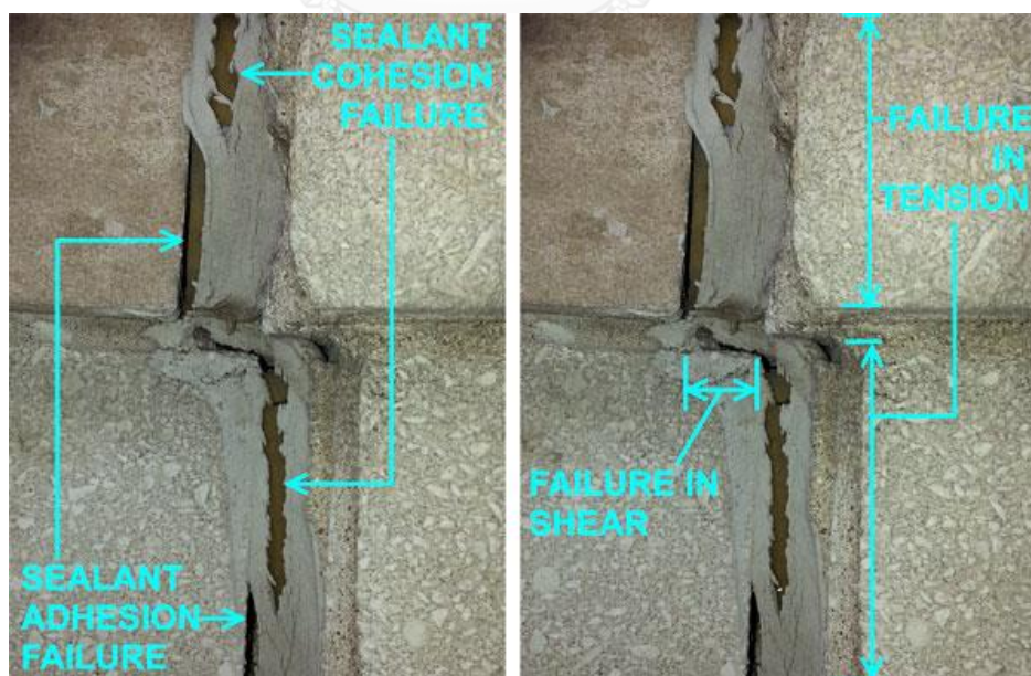
รูปที่ 2. 22 ตัวอย่างการพังของวัสดุอุดรอยต่อด้วยแรงดึงและแรงเฉือน
