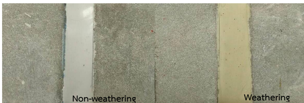
รูปที่ 4. 1 สีที่เปลี่ยนแปลงไปของชิ้นส่วนตัวอย่างที่ไม่ผ่านการเคลือบสารเคลือบผิวอะคริลิก (NC)
