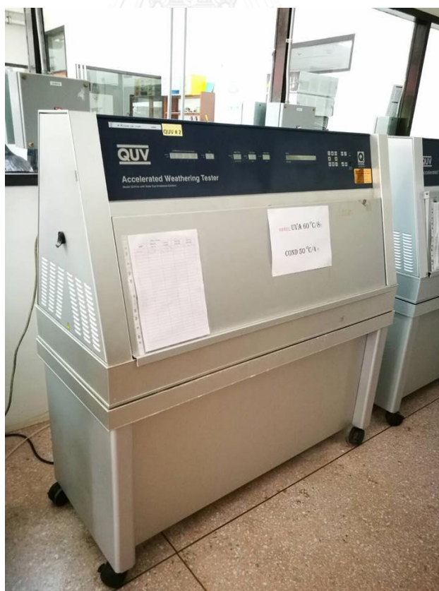
รูปที่ 3. 7 เครื่องทดสอบเร่งปฏิบัติการจำลองสภาพอากาศ
