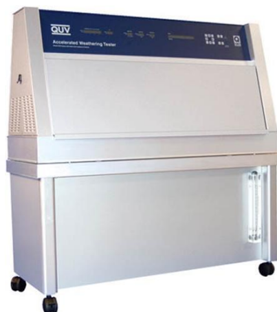
รูปที่ 2. 10 เครื่องทดสอบเร่งปฏิกิริยาจำลองสภาพอากาศ (QUV accelerated weathering tester) (Qlab corporation 2011)
