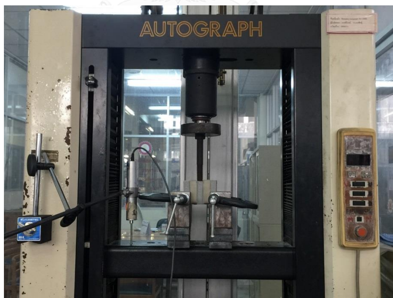
รูปที่ 4. 15 การติดตั้งชิ้นส่วนตัวอย่างที่ใช้ทดสอบแรงเฉือน
