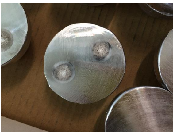
รูปที่ 4.10 โลหะที่นำไปวิเคราะห์ด้วยเครื่อง Optical Emission Spectrometer
