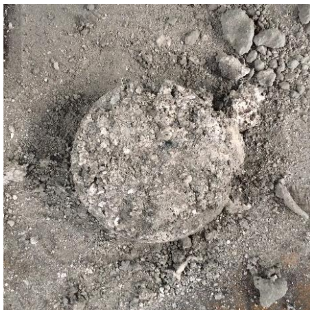
รูปที่ 4.8 ตัวอย่างตะกัณอะลูมิเนียมหลังจากผ่านการทดลองที่อุณหภูมิเริ่มต้นของเตาครุชีเบิลน้อยกว่า 300 องศาเซลเซียส
