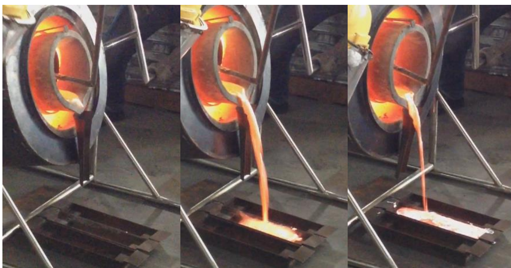
รูปที่ 4.6 ขั้นตอนการเทน้ำโลหะอะลูมิเนียมลงในแม่พิมพ์
