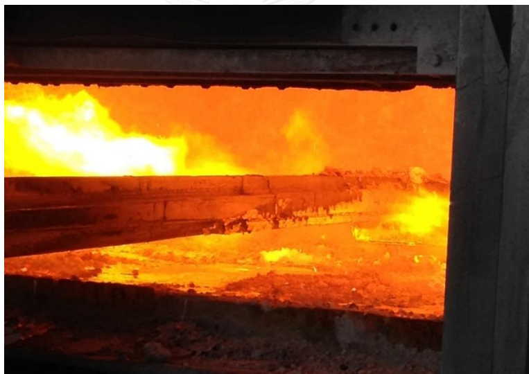
รูปที่ 3.1 ตะกรันอะลูมิเนียมที่เกิดขึ้นจากกระบวนการผลิตอะลูมิเนียมในโรงงาน
