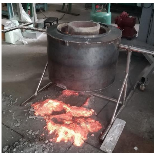
รูปที่ 4.9 ตะกัณอะลูมิเนียมที่ลุกไหม้
