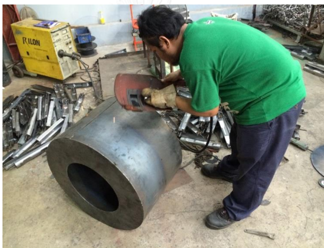
รูปที่ 3.10 การสร้างอุปกรณ์ที่ใช้ในการให้ความร้อนของเครื่องต้นแบบ
