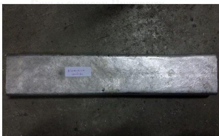
รูปที่ 4.1 โลหะอะลูมิเนียมที่ได้กลับคืนจากการทดลองในห้องปฏิบัติการ
