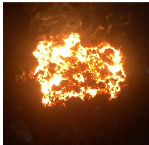
รูปที่ 4.5 ตะกรันอะลูมิเนียมที่ถูกกวาดออกมาจากเตาหลอมของโรงงาน
