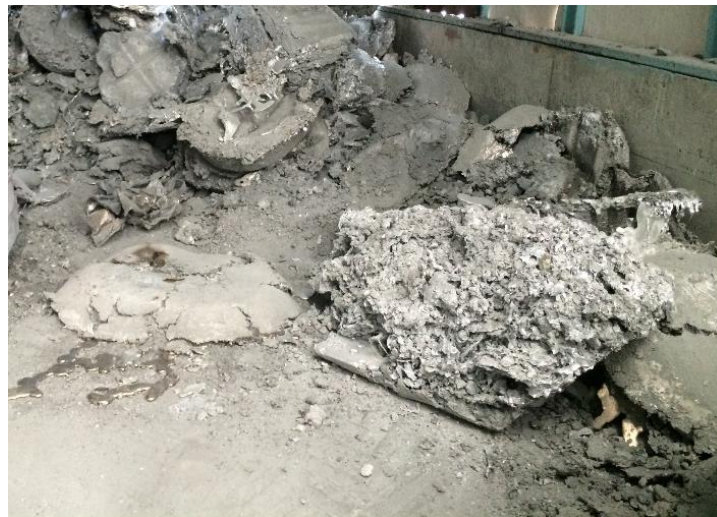
รูปที่ 4.3 ตะกรันอะลูมิเนียมที่อยู่โรงเก็บตะกรันอะลูมิเนียมของโรงงาน
