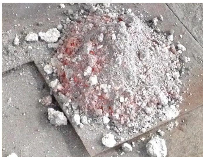
รูปที่ 3.3 ลักษณะของตะกรันที่ยังร้อนอยู่
