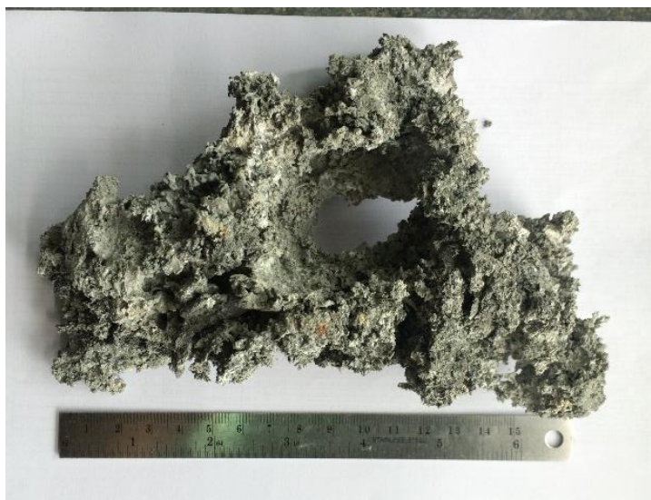
รูปที่ 3.2 ลักษณะของตะกรันที่เย็นตัวแล้ว
