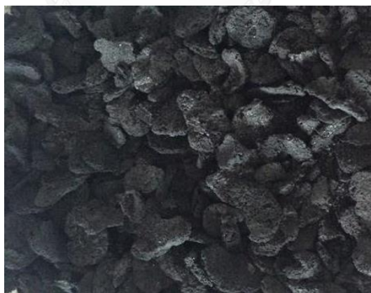
รูปที่ 19 ถ่านกัมมันต์ที่ได้จากแบคทีเรียเซลลูโลส
