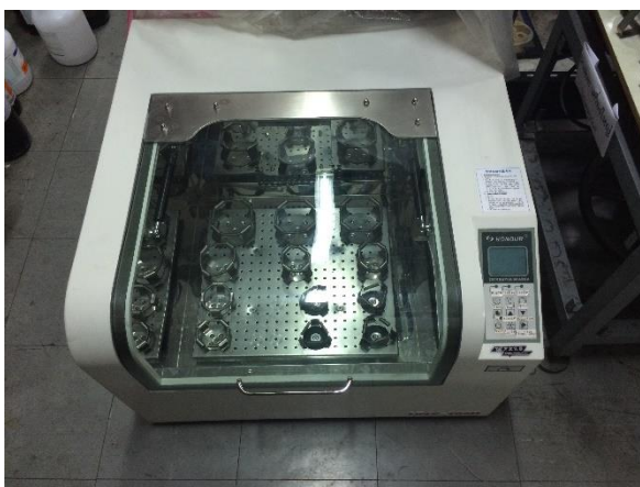
รูปที่ 12 เครื่องควบคุมอุณหภูมิแบบเขย่าใช้ในการทำปฏิกิริยาทรานส์เอสเทอร์ฟิเคชัน
