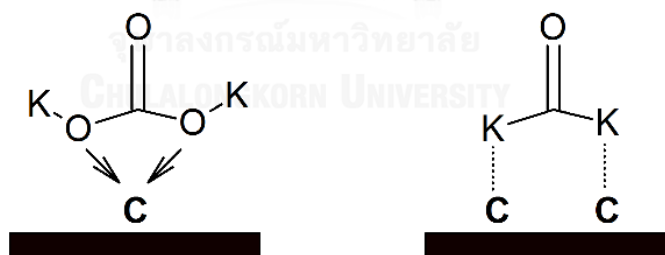
รูปที่ 58 การเกิด K_2CO_3 และ K_2O บริเวณพื้นที่ผิวของถ่านกัมมันต์ [103]
