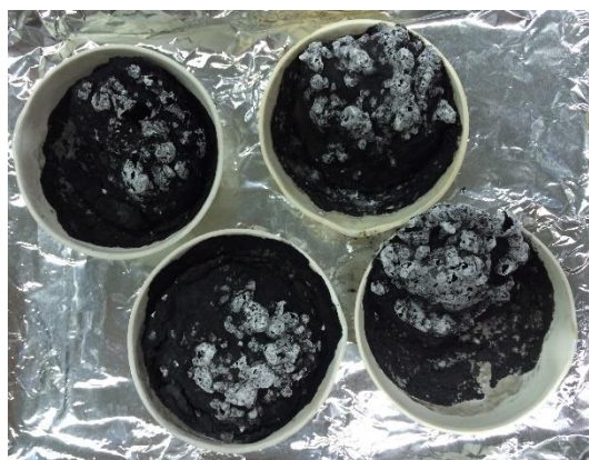
รูปที่ 18 แบคทีเรียเซลลูโลสที่ผ่านการคาร์บอนไซซ์
