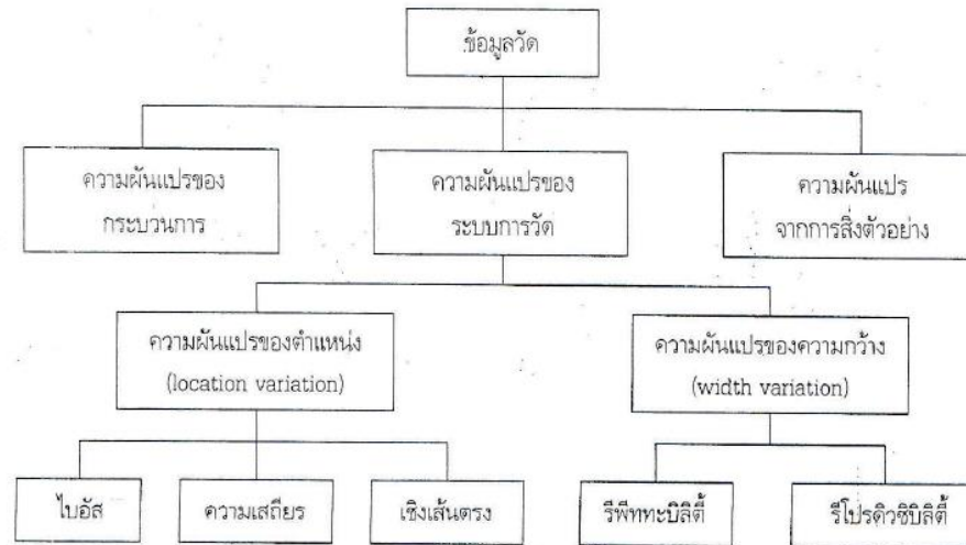
รูปที่ 2.6 องค์ประกอบความผันแปรของระบบการวัด (กิตติศักดิ์ 2546)
