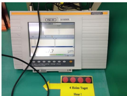
รูปที่ 4.1 เครื่องวัด Cu Scope (Fisher Scope)
