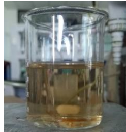
รูปที่ 4.2 ลักษณะการสลายตัวของเมมเบรนแบบเชื่อมขวางในสารละลายซิลเวอร์ไนเตรต
