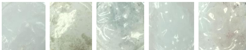
รูปที่ 4.4 ลักษณะภายนอกของเมมเบรนที่ผ่านการปรับปรุงพื้นผิวหลังจากถูกใช้งานและ/หรือปล่อยให้ทิ้งไว้ (ก) UCD 0.005 (ข) UCD 0.01 (ค) UCD 0.05 (ง) CD 0.005 (จ) CD 0.01
