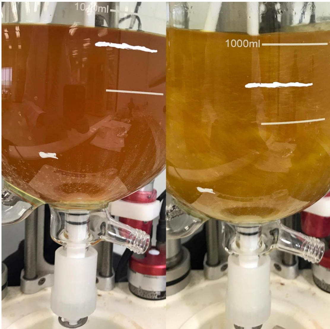
รูปที่ 44 การกระจายตัวของโพแทสเซียมคาร์บอเนตที่ความเร็วรอบ 200 รอบต่อนาที (ซ้าย)และ 700 รอบต่อนาที (ขวา)
