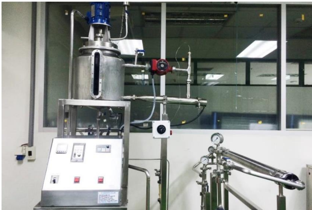
รูปที่ 23 เครื่องปฏิกรณ์ขนาด 10 ลิตร [28]
