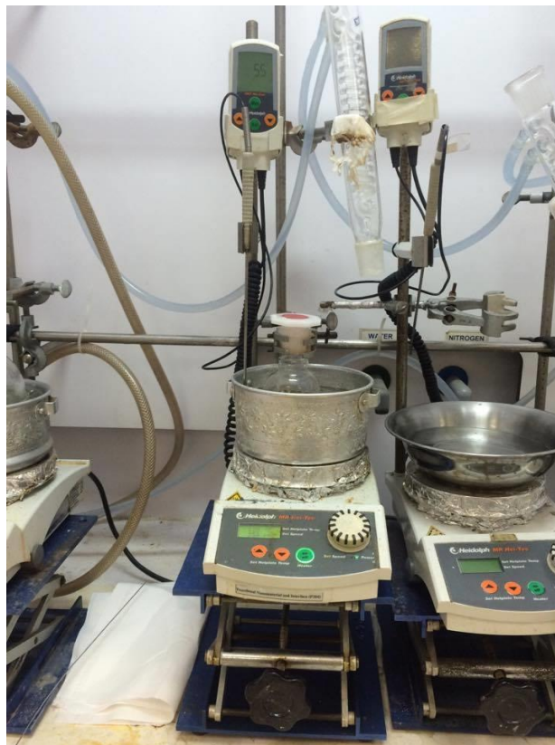
รูปที่ 21 เครื่องปฏิกรณ์ขนาด 250 มิลลิลิตร
