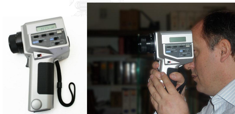
ภาพที่ 3-31 เครื่องวัดแสง (Luminance meter) และวิธีใช้การงาน (Konica Minolta, 2016)
