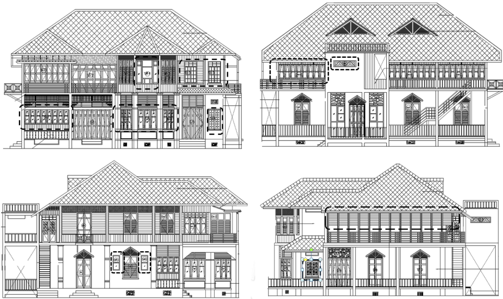
ภาพที่ 25 รูปด้านแสดงสัดส่วนหน้าต่างกระจกและแผงบังแดดของอาคารกรณีศึกษา
