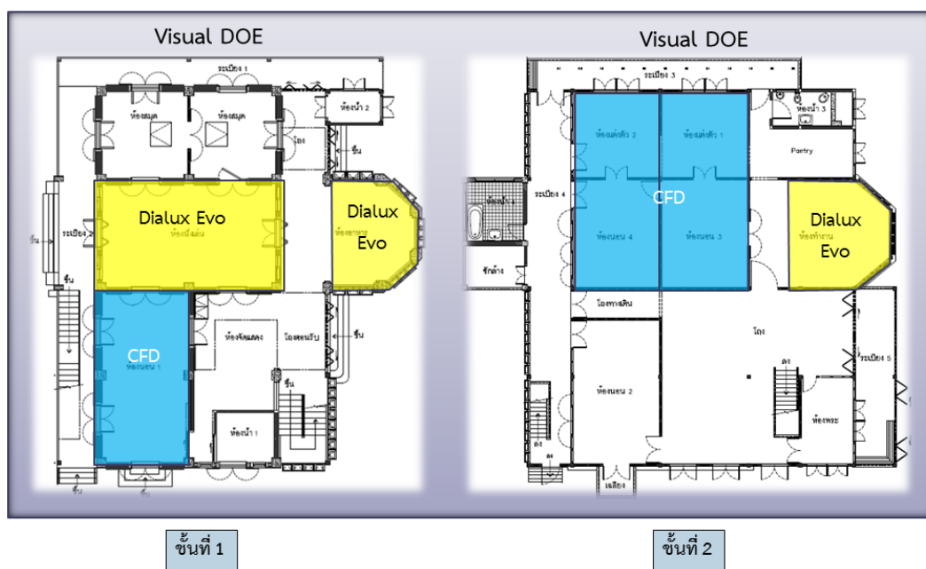
ภาพที่ 10 การกำหนดพื้นที่เพื่อทำการจำลองโปรแกรมคอมพิวเตอร์
