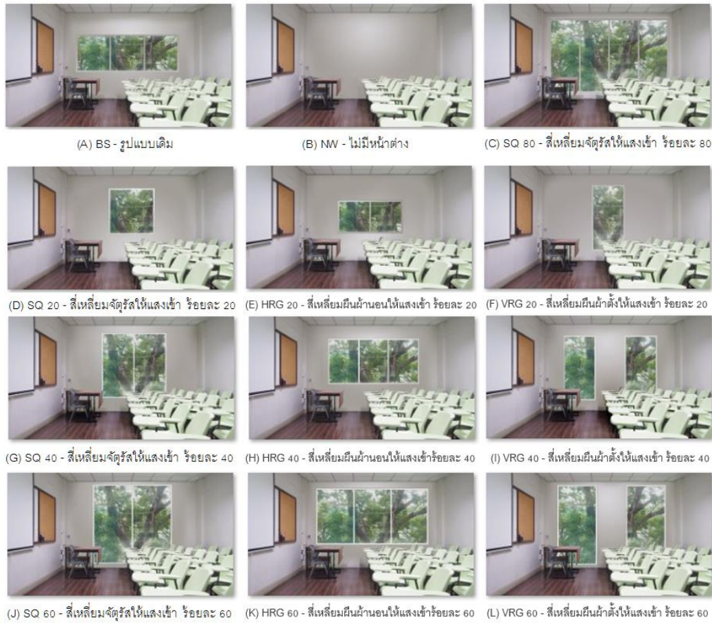
รูปที่ 3.8 รูปแบบหน้าต่างของห้องเรียน ที่มีอัตราส่วนหน้าต่างต่อผนัง และรูปแบบหน้าต่าง ต่างๆ กัน
