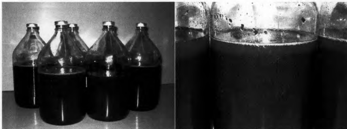
ภาพที่ 3.3 การสร้างความคุ้นเคย ของตะกอนเมื่อดูลินทรีย์ให้เข้ากับตัวอย่างน้ำเสีย
