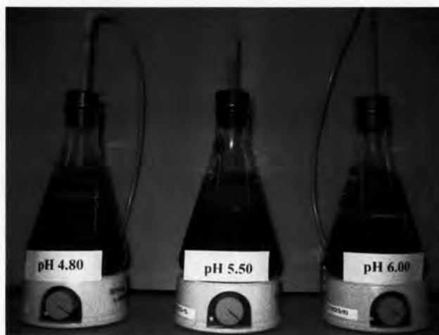
ภาพที่ 3.8 การทดลองไฮโดรไลซิสตัวอย่างน้ำเสียจากโรงงานสกัดน้ำมันปาล์ม
