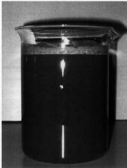
ภาพที่ 3.1 ลักษณะทางกายภาพของน้ำเสียจากโรงงานสกัดน้ำมันปาล์ม
