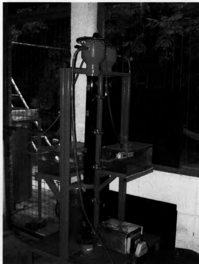
ภาพที่ 3.10 การเดินระบบถังสร้างก๊าซมีเทนแบบยูเอสบี (UASB)
