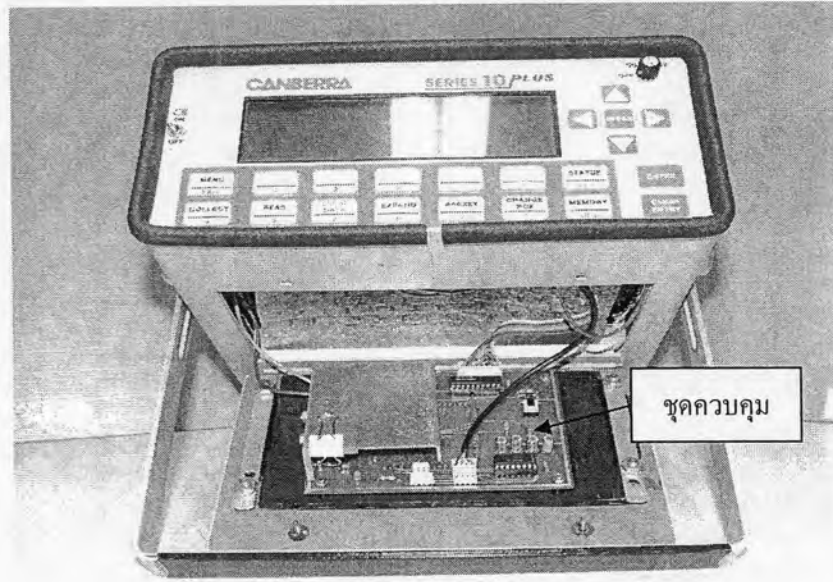
ก. ชุดควบคุมที่ประกอบเข้ากับเครื่อง Canberra Series 10 Plus
