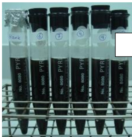
รูปที่ 4.1 หลอดทดลองเพื่อทดสอบสารเคมีชะลอการเกิดตะกอน
