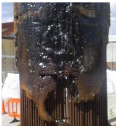
รูปที่ 3.17 ตะกรันชนิดจากการเกิดปฏิกิริยาเคมี
