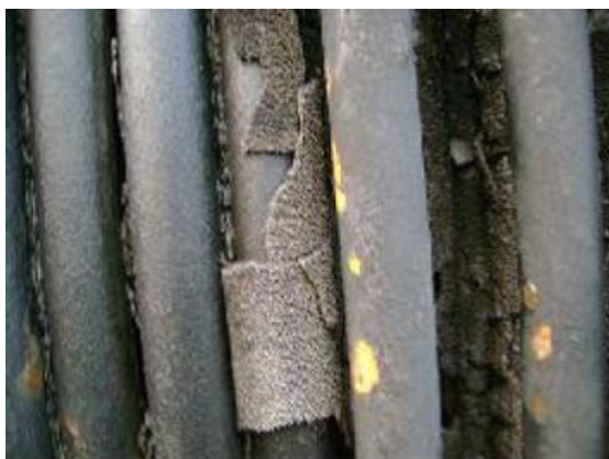
รูปที่ 1.3 ความหนาของตะกรันที่ผิวหม้อต้มซ้ำ ส่งผลต่อประสิทธิภาพการแลกเปลี่ยนความร้อน
