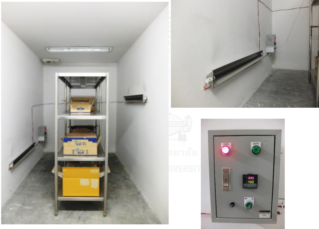
รูปที่ 3.2 สถานที่เก็บตัวอย่างและอุปกรณ์ให้ความร้อนสำหรับควบคุมอุณหภูมิ
