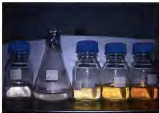
ภาพที่ 7 ลักษณะของสารสกัดโพรพอลิสเมื่อผ่านการกรองสุญญากาศแล้ว (จากซ้ายไปขวา น้ำกลั่น, 5%, 40%, 70% และ 95% ethyl alcohol)
