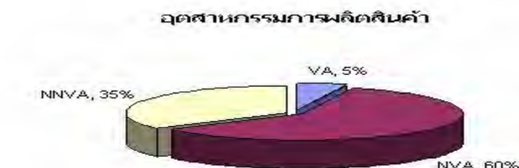
ภาพที่ 2.3 สัดส่วนของกิจกรรมในอุตสาหกรรมการผลิตสินค้า
