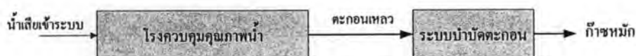
รูปที่ 3.9 ระบบบำบัดน้ำเสียขนาดใหญ่และระบบบำบัดตะกอนแยก
