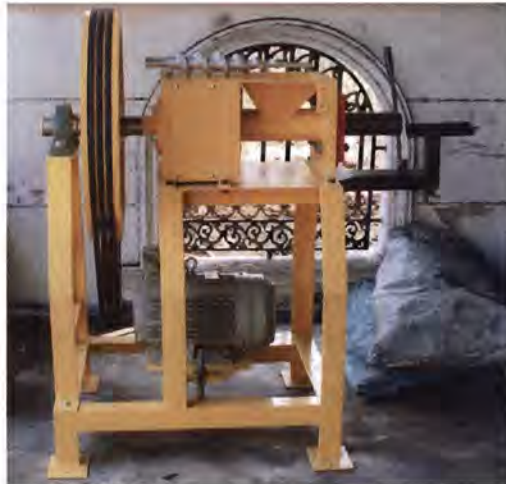
รูปที่ 3-5 เครื่องอัดแท่ง (Extruder) กำลังการผลิต 100 กก./ชม.
