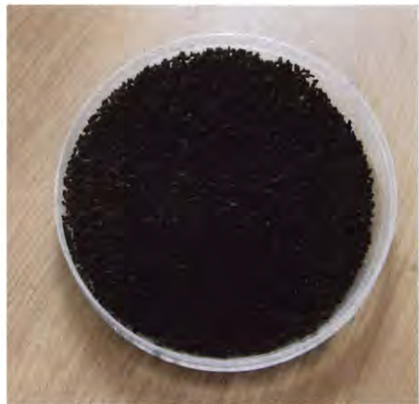
รูปที่ 4.2 ตะกอนเปียกหลังทำการคาร์บอนไนเซชัน
