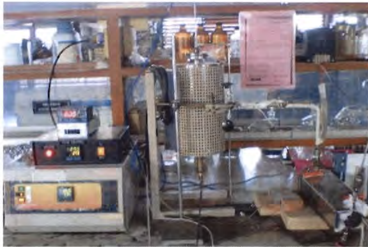
รูปที่ 3.3 ชุดอุปกรณ์เครื่องมือคาร์บอนไนเซชันตะกอนเปียก
