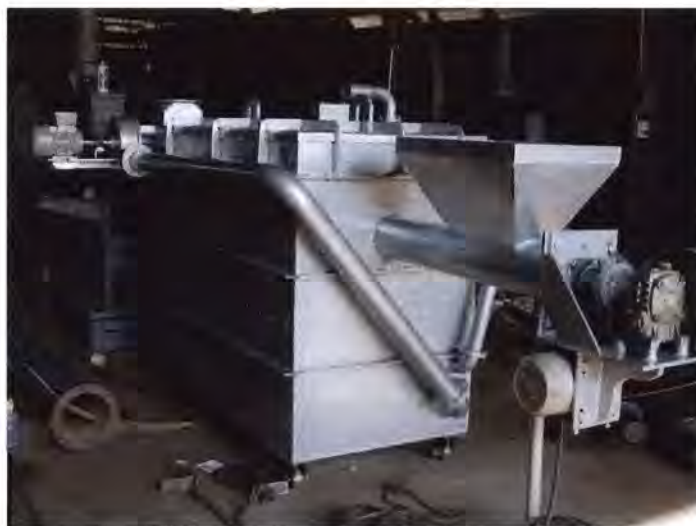
รูปที่ 3.2 เครื่องอบไล้ความชื้นตะกอนเปียก Screwdry กำลังการผลิต 100 กก./ชม.
